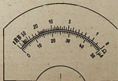
Bild 112. Skala des Ohmmeters nach Schaltung Bild 111
